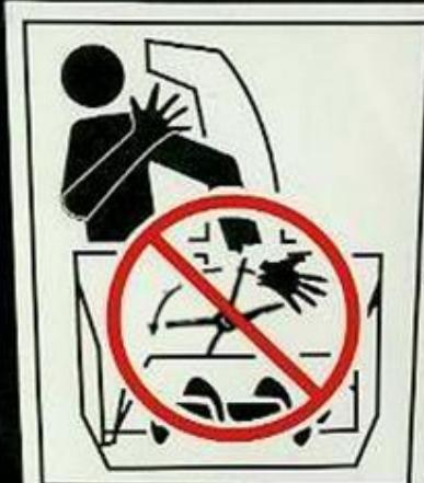
Остановите двигатель перед прочисткой разгрузочного желоба!
