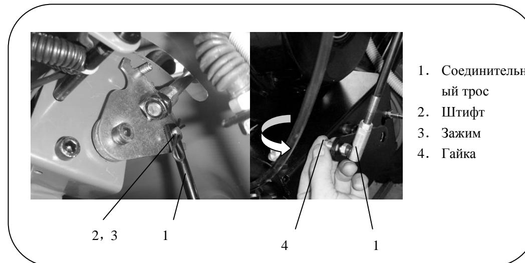
3 Установка рычага: протяните рычаг к стороне шарнира от панели управления так, чтобы отверстие рычага попадало в отверстие шарнира, а затем вставьте зажим.
