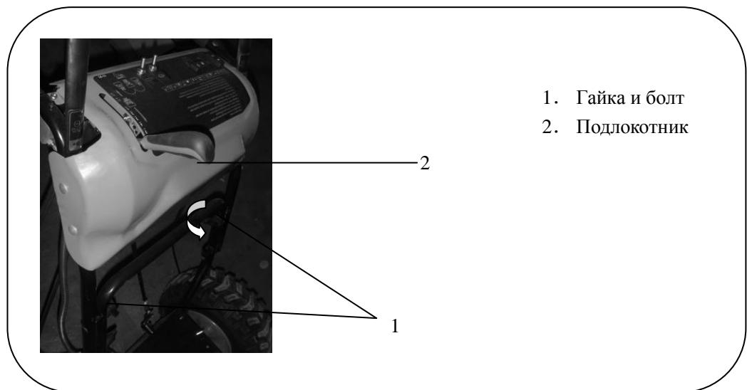
4. Установите соединительный трос: выньте зажим и штифт, проденьте через отверстие в трофе штифт и зафиксируйте его зажимом, закрутите с другой стороны гайку.
